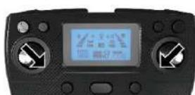
După pornire, mișcați maneta stângă în colțul stânga jos și maneta dreaptă în colțul dreapta jos simultan (Figura 1), sau mișcați-le spre interior simultan (Figura 2), pentru a debloca drona, acum motoarele se pot învărti iar drona poate decola.
